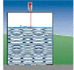
用徕卡迪士通 OEM 测量透明液质表面时，可采用一个铅锤吊着一个浮标充当反射面。
